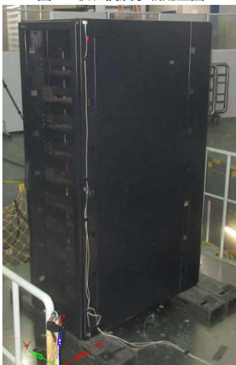
图 7：机柜抗震测试设备上照片
