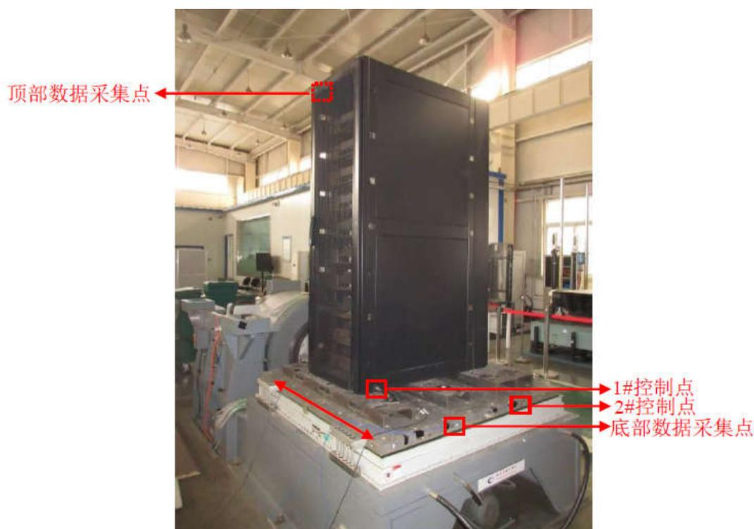
图 5：机柜动态测试现场照片
